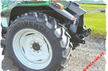
**JAKE 350** позволяет использовать манипулятор многосторонне, так как манипулятор установленный на тракторе можно комбинировать с другим оборудованием соединяющимся с задней 3-х точечной навесной системой или прицепным устройством. Возможны ограничения в агрегатировании с машинами, но причина обычно гидроманипулятор, а не **JAKE 350**.
